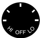
Bouton de commande du ventilateur d'aération
