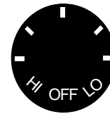
Perilla de control del ventilador del escape
